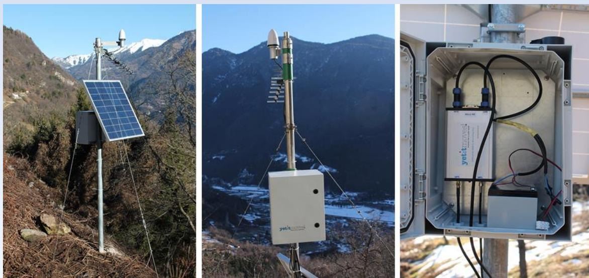
*Stazioni DISPLAYCE monumentate al suolo in aree soggette a frana. Nelle foto si possono notare il ricevitore e la batteria tampone ospitati da armadio con protezione IP66 ancorato ad un palo attraverso opportune staffe di fissaggio*
